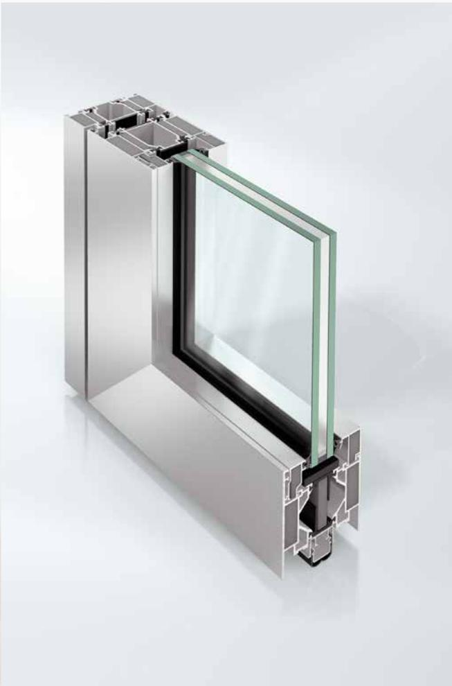
Das bewährte Türsystem ADS 80 FR 60 (Fire Resistant) mit der Bautiefe 80 mm basiert auf hochstandfesten 5-Kammer-Hohlprofilen. Es ist geeignet für Tür- und Wandelemente für Brandschutz der Feuerwiderstandsklasse EI60 (T60, F60).
