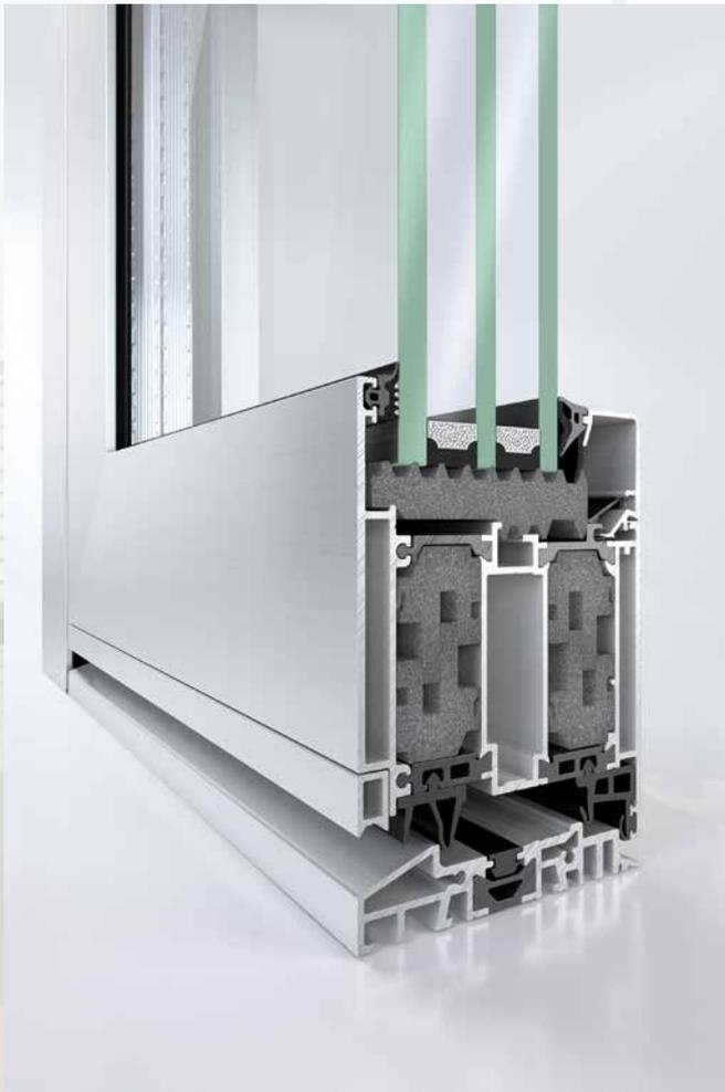
Konzipiert für anspruchsvollste Projektlösungen im Wohn- und Objektbau: Das hochstabile Türsystem AD UP 90 mit einer Bautiefe von 90 mm basiert auf einem 3-schaligen Konstruktionsprinzip mit doppeltem Mitteldichtungssystem, das höchste Energieeffizienz, Dämm- und Dichttheitseigenschaften sichert.
