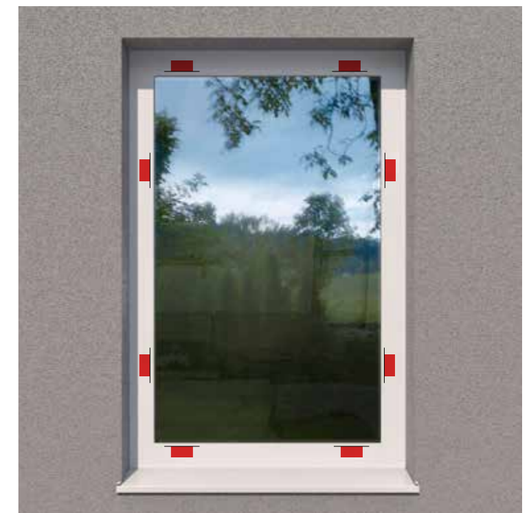
Standardmäßige Anordnung der I-tec Secure Verriegelungspunkte
