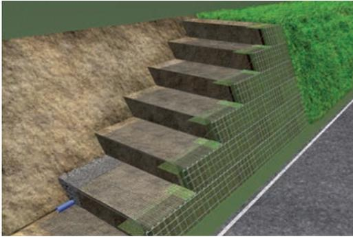
POLYSLOPE® S ist ein begrünbares System zur Errichtung von Geokunststoff bewehrten Erdstützkonstruktionen mit einer Neigung von 70°. Konstruktionshöhen ab 0,60 m bis zu über 20 m sind möglich. Das System ist umweltfreundlich, leicht zu bauen und eine technische und wirtschaftliche Alternative zu konventionellen Hangverbauten, wie etwa Stein- und Betonmauern.
